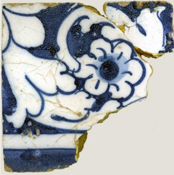
Azulejo com craquelé e linhas de fissura bem evidenciadas. O centro evidencia uma pequena área com empolamento.
